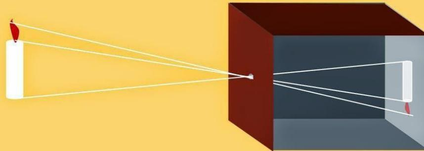
*En la cámara oscura, la formación de la imagen invertida, es consecuencia de la propagación rectilínea de la luz.*
